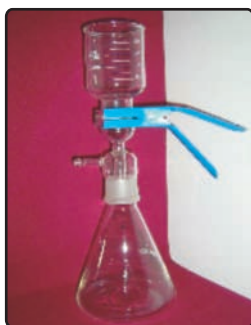
KOLBA PRÓŻNIOWA DO ZESTAWU FILTRACYJNEGO
